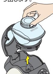
コーヒータンクのフタを反時計回りに回して外します。
