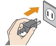
電源プラグをコンセント（100 V、50 / 60 Hz）に直接差し込んでください。
